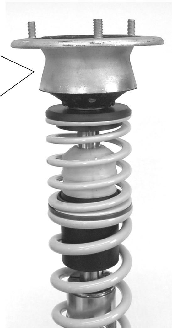
Nach erfolgtem Einbau des Fahrwerkes ist die Freigängigkeit der Bereifung zum VA Federbein zu überprüfen. Das Mindestabstandsmaß an der engsten Stelle darf **5 mm** nicht unterschreiten und ist gegebenenfalls mittels handelsüblicher, TÜV geprüfter Distanzscheiben wieder herzustellen.
