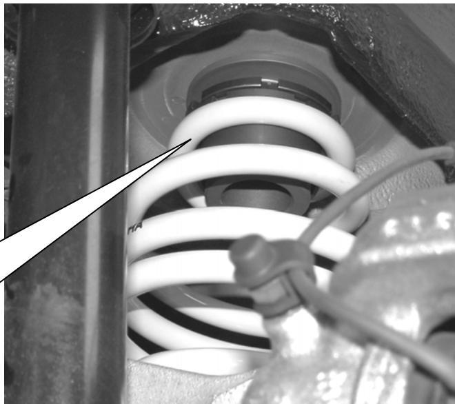
Die Höhenverstellung (Gewindehülse und Nutenring) ist oben an der Feder einzusetzen. Zum Korrigieren der Fahrzeughöhe ist der Stoßdämpfer an der Achse zu lösen und die Verstellung zu entlasten bzw. zu demontieren
