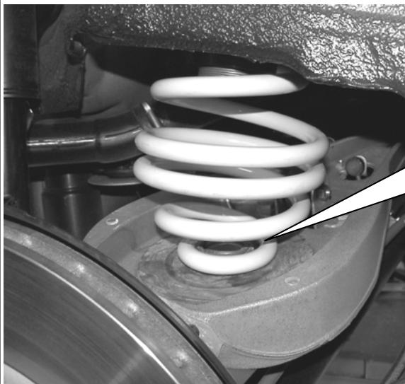
Die serienmäßige Federunterlage, die oben an der Feder eingesetzt ist, muss nun unten zwischen Feder und Querlenker eingesetzt werden.
