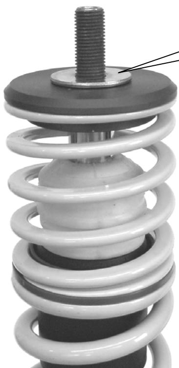
Das Original Stützlager aufsetzen und mit der mitgelieferten Stoppmutter verschrauben. Das Anzugsdrehmoment der Kolbenstangenbefestigung beträgt 50 Nm. Die Montagehinweise zum Einbau des Federbeines in das Fahrzeug, sowie die Anzugsdrehmomente der Federbeinbefestigung, entnehmen Sie bitte den Unterlagen des Fahrzeugherstellers.
