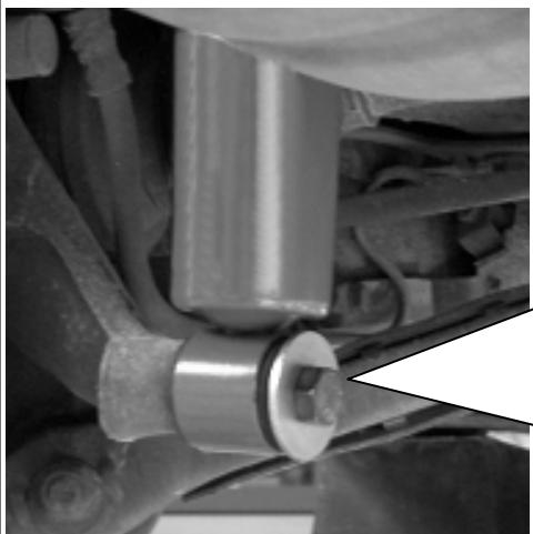
Bei der unteren Dämpferbefestigung muss die mitgelieferte Beilagscheibe eingebaut werden. Dabei darauf achten, dass die Scheibe in Richtung Fahrzeugmitte montiert wird (siehe Bild). Die Montagehinweise zum Einbau des Dämpfers in das Fahrzeug, sowie die Anzugsdrehmomente der Dämpferbefestigung, entnehmen Sie bitte den Unterlagen des Fahrzeugherstellers.
